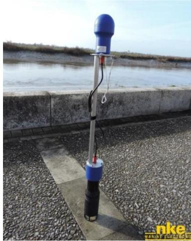
Figure 23 : Sonde multi paramètres placée à Tonny-Charente par l’EPTB Charente
