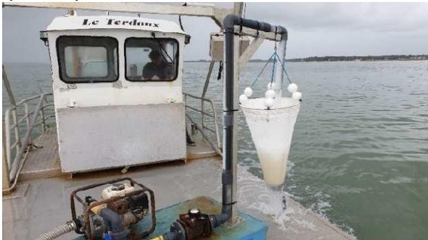
L'eau prélevée est filtrée dans un filet à plancton, de maille de 40 microns, qui assure la rétention des larves. Les prélèvements sont récupérés et conservés dans des bidons acheminés au laboratoire pour la réalisation des comptages.
