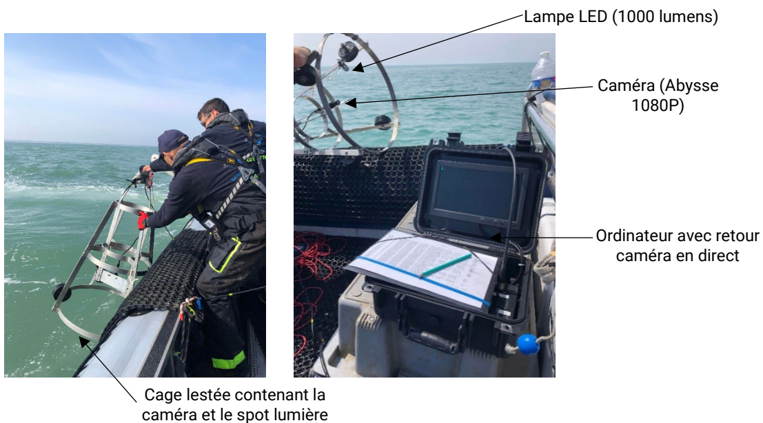
Figure 13 : Principe du système de vidéo stationnelle mis en œuvre dans le cadre de REFONA
