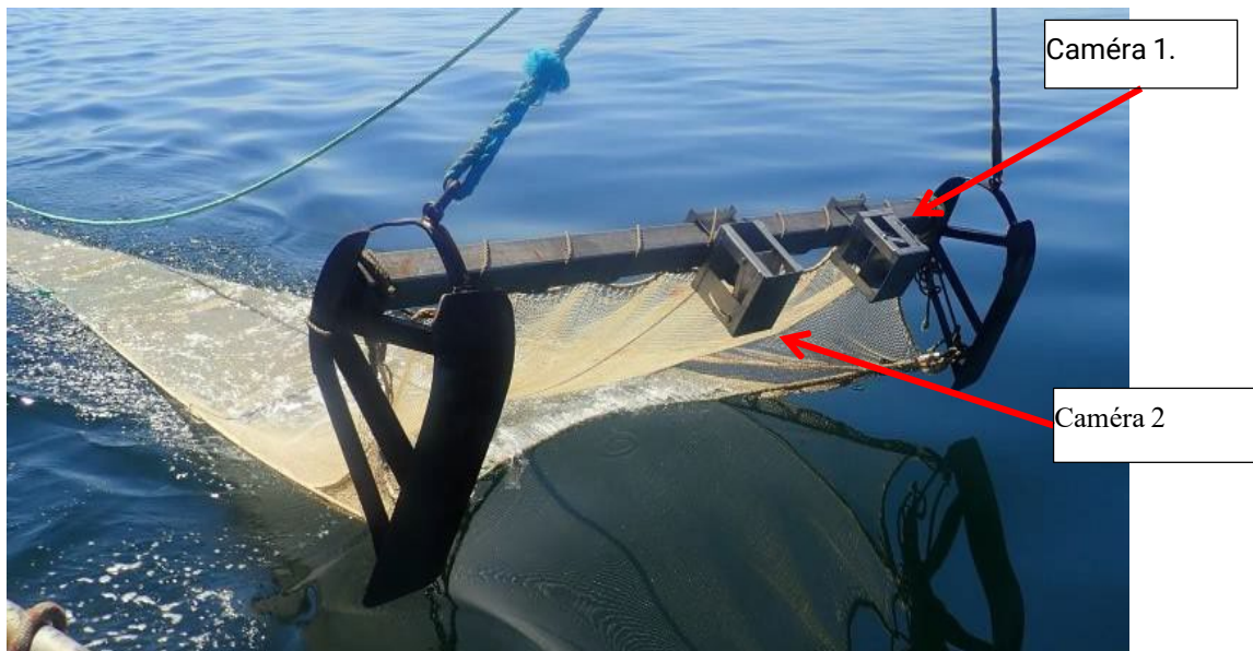
Figure 2 : caméra fixées sur une barre de chalut avec les patins (Conception Bio-Littoral).
